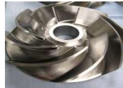
Neu Teil fräsen aus Rohling
